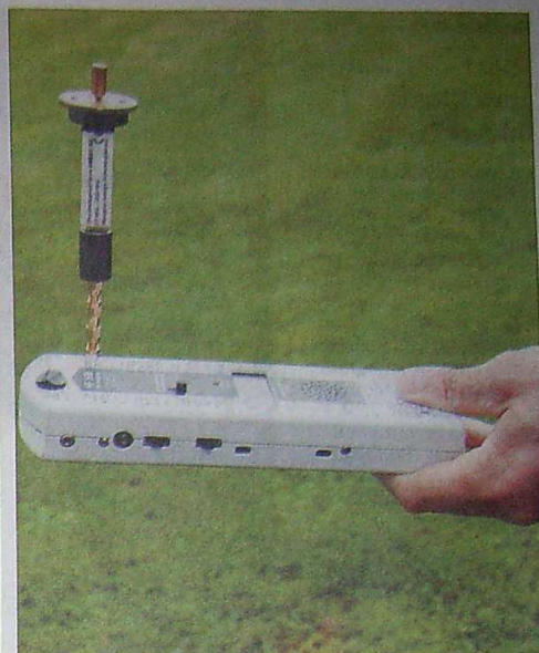
Mit dieser Antenne lässt sich das Breitbandmessgerät auf den 360-Grad-Rundum-Modus umrüsten.
